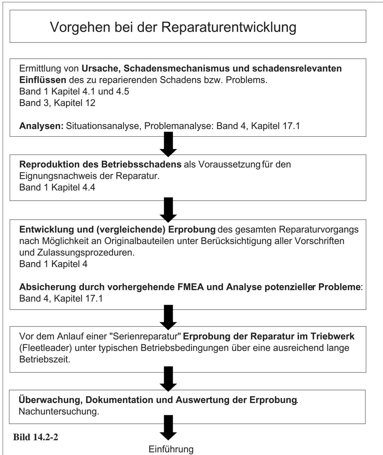
**Bild 14.2-2** (Lit. 14.2-1 und Lit. 14.2-2): Um besondere Risiken einer **Reparaturoentwicklung** (Bild 14.2-1) zu minimieren, lässt sich eine Abfolge **empfehlenswerter Einzelschritte** angeben.
