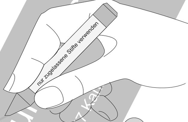
Stempel sind eine hufig vorgeschriebene Kennzeichnungsart, z.B. bei der Qualittssicherung. Stempelfarbe kann nachfolgende Fertigungsprozesse beeinflussen. Falsche Stempelfarbe kann sogar Werkstoffe schdigen.
