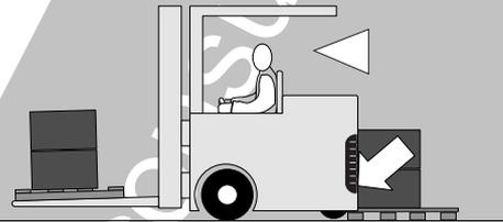
Beschädigung der Bauteile beim Aufnehmen
